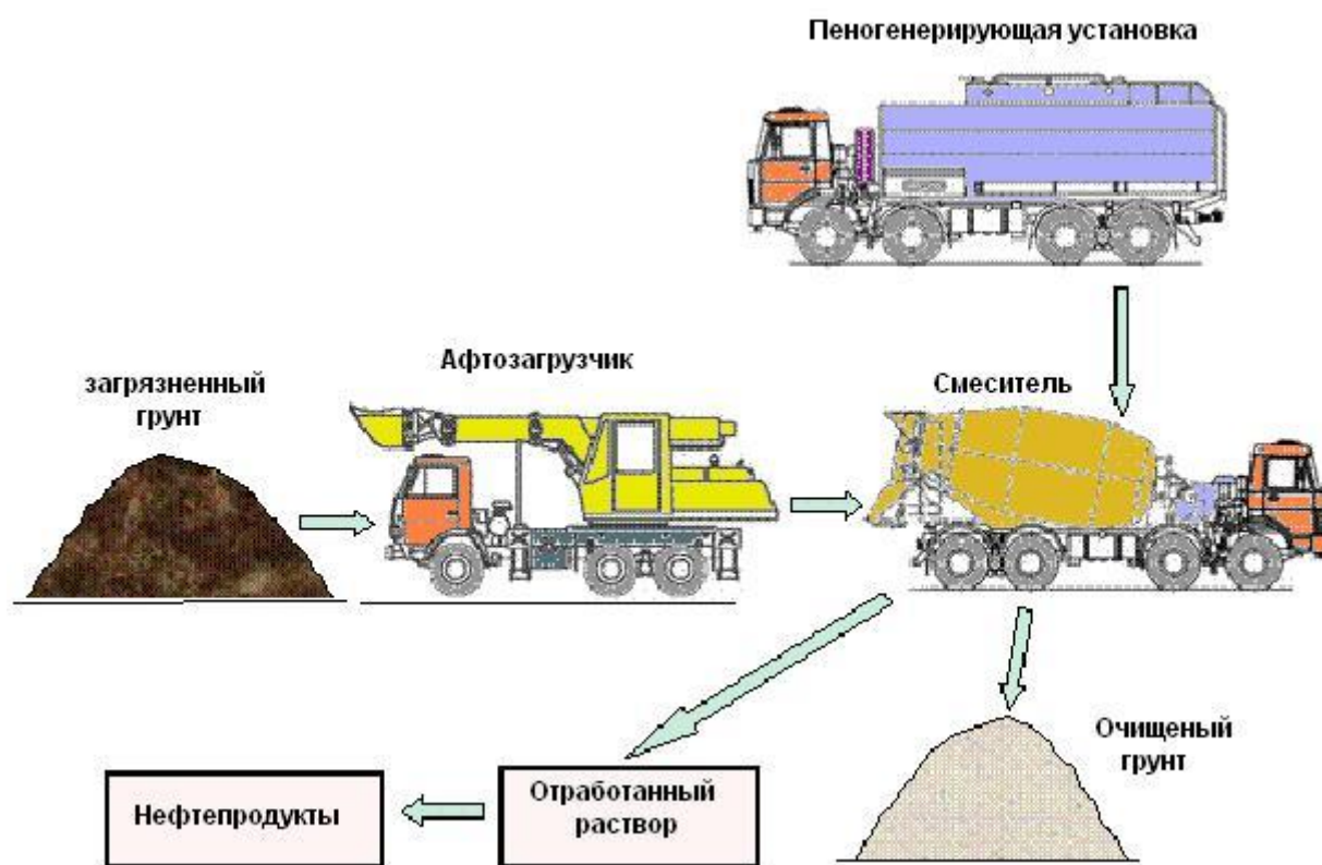
Сурет - 5 Арнайы су көбіктенетін ерітінді көмегімен ластаңған топырақты тазалаудың технологиялық схемасы
